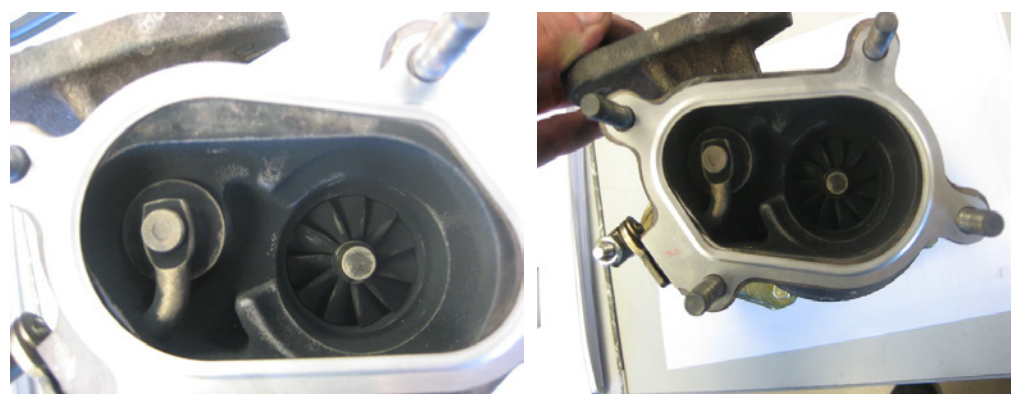
Nesprávně namontované těsnění
