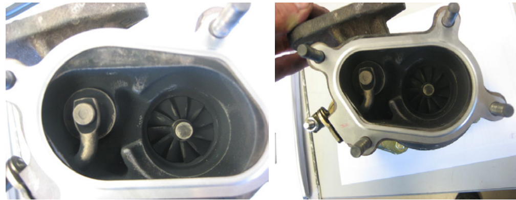
Junta montada incorrectamente
