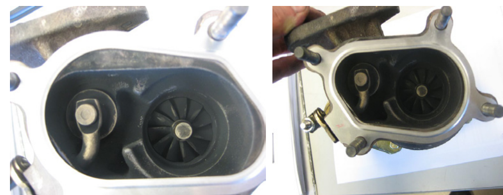
Falsch eingebaute Dichtung
