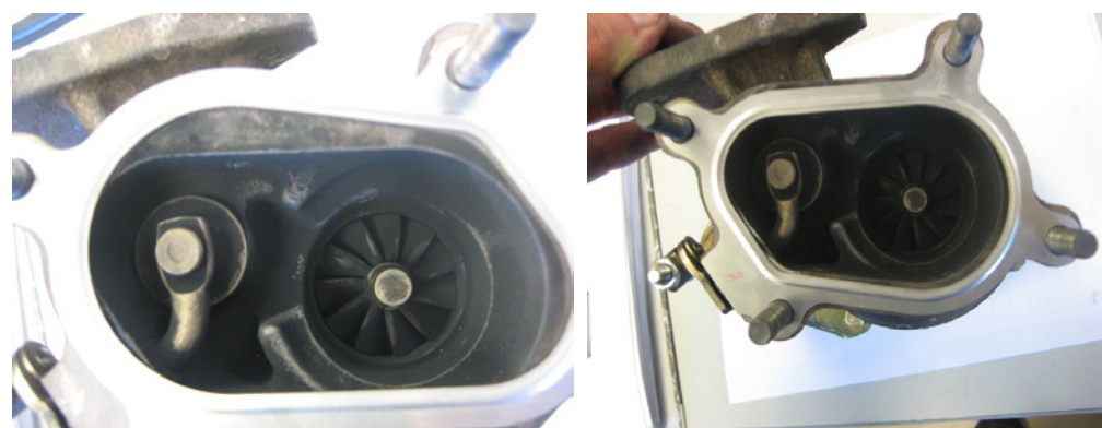
Pakning forkert monteret
