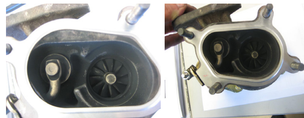
Garnitură montată incorect
