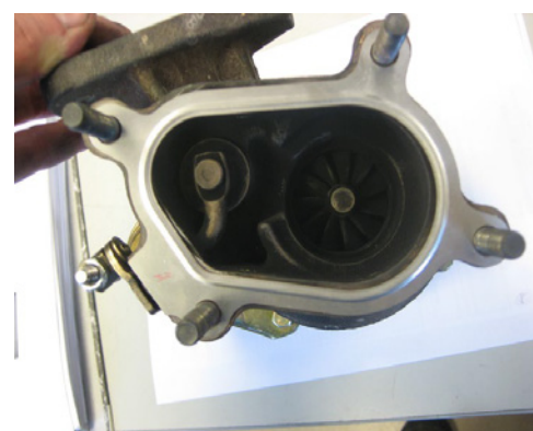
Megfelelően felszerelt tömítés
