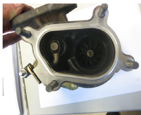
Junta montada corretamente
