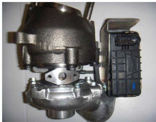
Når den er monteret på køretøjet, fungerer turboen muligvis ikke korrekt. Dette skyldes, at ECU'en eller DDE'en skal omprogrammeres af den autoriserede tekniske tjeneste for at fungere korrekt, da både positionsreguleringen og diagnostiksystemet er indbygget i servomotoren.
