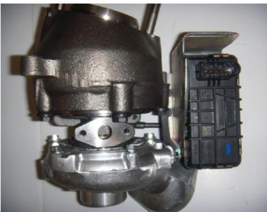
A járműre történő felszerelés után előfordulhat, hogy a turbó nem működik megfelelően. Ennek oka, hogy az ECU-t vagy a DDE-t az arra felhatalmazott műszaki szerviznek újra kell programoznia a helyes működéshez, tekintettel arra, hogy a helyzetszabályozó és a diagnosztika is a szervomotorba van beépítve.
