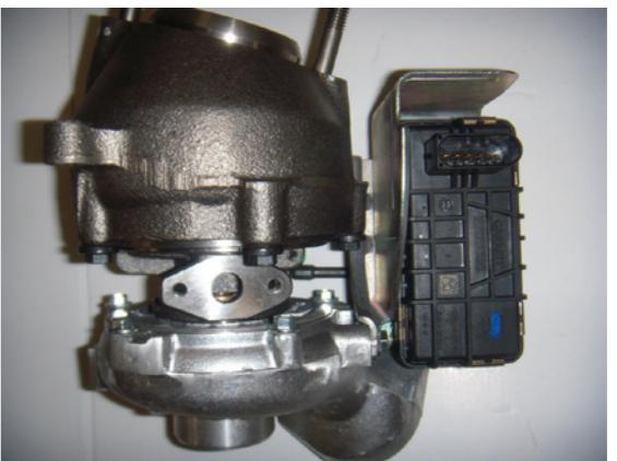
Odată montat pe vehicul, este posibil ca turbocompresorul să nu funcționeze corect. Acest lucru se datorează faptului că ECU sau DDE trebuie reprogramat de către serviciul tehnic autorizat pentru a funcționa corect, dat fiind faptul că regulatorul de poziție și diagnosticul sunt ambele încorporate în servomotor.
