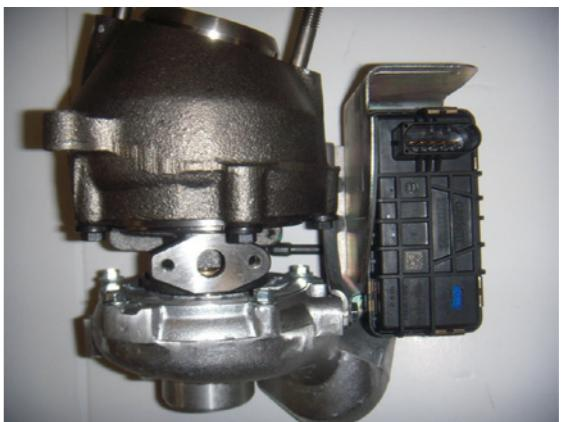
Po zamontowaniu na pojeździe, turbo może nie działać prawidłowo. Wynika to z faktu, że ECU lub DDE musi zostać przeprogramowane przez autoryzowany serwis techniczny, aby funkcjonować prawidłowo, biorąc pod uwagę, że zarówno regulator położenia, jak i diagnostyka są wbudowane w serwomotor.
