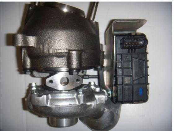
Es kann vorkommen, dass der Turbolader nach der Montage im Fahrzeug nicht sachgerecht arbeitet. Für die korrekte Funktion ist der Bordcomputer oder die digitale Dieselelektronik (DDE) von einem offiziellen Kundendienst neu zu programmieren, denn der Positionsregler und die Diagnosefunktionen sind in den Servomotor integriert.
