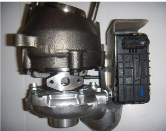
Puede ocurrir que el turbo una vez montado en el vehículo, no funcione correctamente, dado que tiene que ser reprogramada la UCE, o DDE por parte de un servicio oficial, para su correcto funcionamiento, dado que el regulador de posición y las funciones de diagnóstico están integradas en el servomotor.
