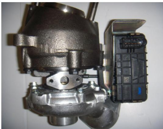
Může se stát, že po namontování do vozu nebude turbodmychadlo správně fungovat. Aby řádně pracovalo, je nutné v oficiálním servisu přeprogramovat UCE nebo DDE, protože regulátor polohy a funkce diagnostiky jsou integrované v servomotoru.
