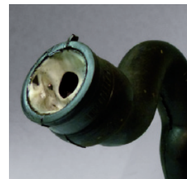
Respiradero del cárter: bloqueado por la emulsión de agua condensada y aceite de motor
