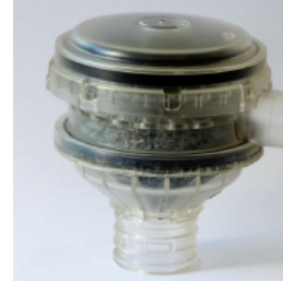
Yağ karteri havalandırması ve yağ buharı separatörü
