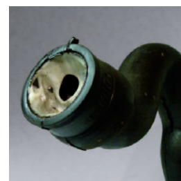
Система вентиляции картера забита эмульсией, состоящей из конденсата и моторного масла
