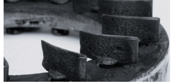
VTG: Yoğun kurum birikintisi mekanizmayı bloke ediyor
