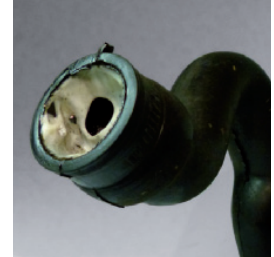
Yağ karteri havalandırması: Yoğuşma ve motor yağından oluşan bir çözeltiyle bloke olmuş
