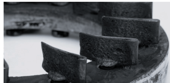
TGV : d'épais dépôts de calamine bloquent le mécanisme
