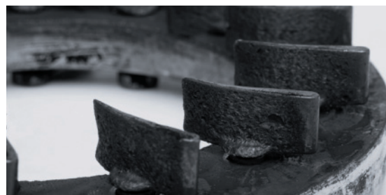
VTG: Znaczne osady nagaru olejowego blokują układ mechaniczny
