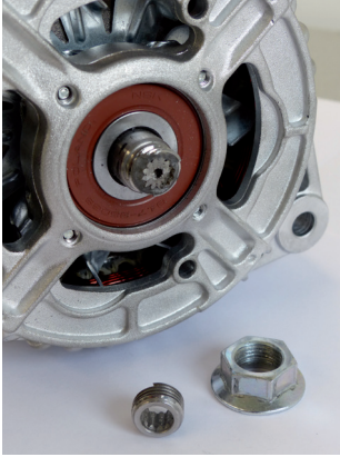
Resim 1: Kırılmış vida dişi
