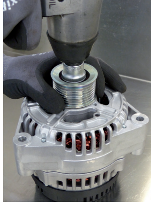
Resim 2: Darbeli anahtar, yalnızca alternatör kasnağını sökmek için kullanılmalı ve sıkmak için KULLANILMAMALIDIR!
