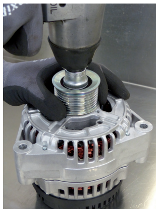
Figure 2 : Utilisez une visseuses à percussion uniquement pour desserrer la poulie, PAS pour la serrer !
