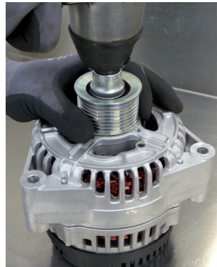
Εικόνα 2: Τα γαλλικά κλειδιά κρούσης επιτρέπεται να χρησιμοποιούνται μόνο για το λύσιμο της τροχαλίας ιμάντα, ΟΧΙ για σύσφιξη!
