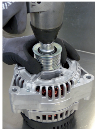
Abbildung 2: Schlagschrauber dürfen nur zum Lösen der Riemenscheibe benutzt werden, NICHT zum Festziehen!
