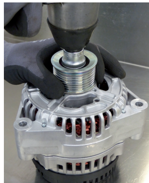
Figura 2: ¡Los destornilladores percutores solo se pueden usar para soltar la polea, NO para apretarla!
