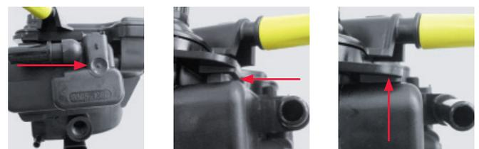
Anschließend die untere Kante des Heizers gegen den Filter drücken, damit diese in den unteren Klippbereich einrasten kann. Den korrekten Sitz mit einem Schiebeversuch in Richtung Schnittstelle Heizer/Filter kontrollieren.
