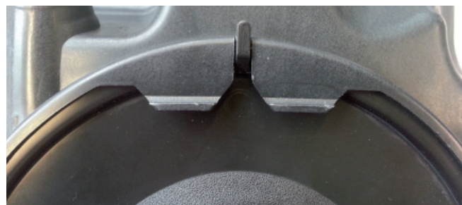
Figure 1 : L'ergot situé sur le disque terminal développé par MAHLE garantit un positionnement correct de l'élément filtrant et ainsi une mesure précise des masses d'air.
