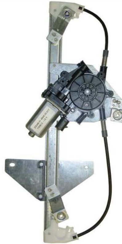
POWER WINDOW LEFT ALZACRISTALLI ELETTRICO SX
