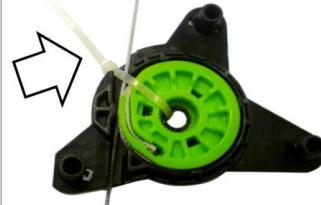
Es wird empfohlen, die Plastiksicherung (Kabelbinder) vom Antrieb erst zu entfernen, wenn der Antrieb mit dem Motor verbunden ist, so wird ein abrollen des Kabels verhindert.
