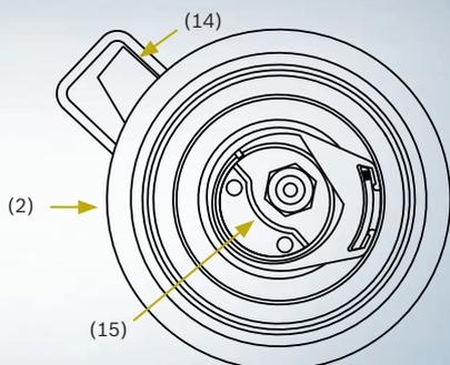
► Positionshaken der Spannrolle (2) korrekt in die Nut einsetzen. **Achtung: der Positionshaken muss an der rechten Nutseite anliegen (14).**
