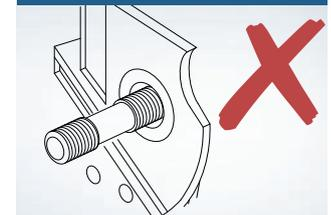
Stehbolzen (6 und 10) nicht bis zum Anschlag eingeschraubt
