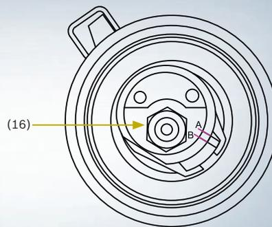
► Nach dem Auflegen des Zahnriemens die Mutter (16) der Spannrolle lösen und die Montageplatte mit dem Zapfenschlüssel im Uhrzeigersinn weiter drehen, bis Zeiger und Kerbe in der Trägerplatte fluchten. (Position A und B). Falls die Spannrolle zu weit gedreht wurde: Ganz nach links gegen den Uhrzeigersinn drehen und Spannvorgang wiederholen. (Angabe in ESI[tronic]-M beachten). Mutter (16) der Spannrolle festdrehen.
