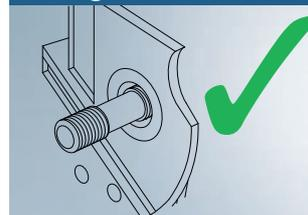
Stehbolzen (6 und 10) bis zum Anschlag eingeschraubt
