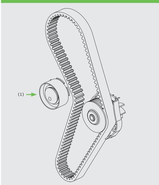
Die Spannrollen (1) können sich je nach Bauart im Design unterscheiden:
