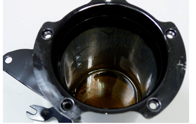
Resim 2: Filtre gövdesindeki eski dizel yakıt
