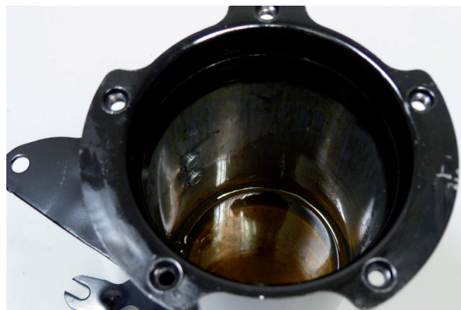
Рисунок 2: Остатки старого дизельного топлива в корпусе фильтра
