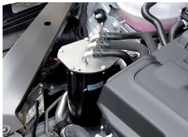
Рисунок 3: Корпус фильтра в моторном отсеке
