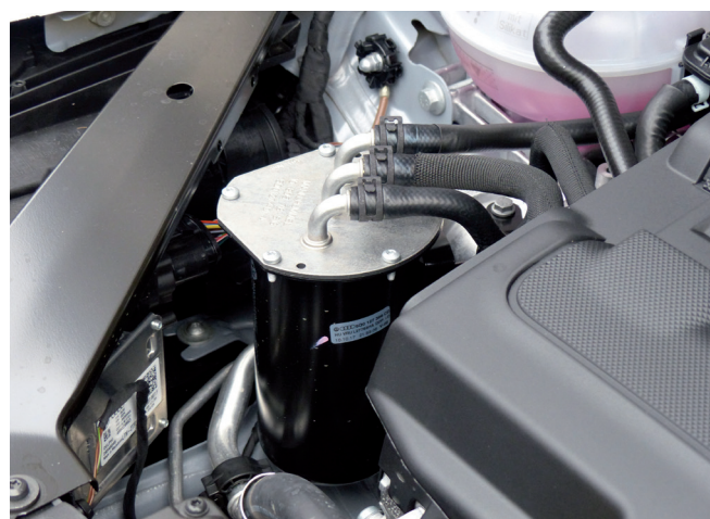
Rysunek 3. Obudowa filtra w komorze silnika
