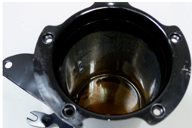
Figure 2 : Gazole usagé dans le boîtier de filtre
