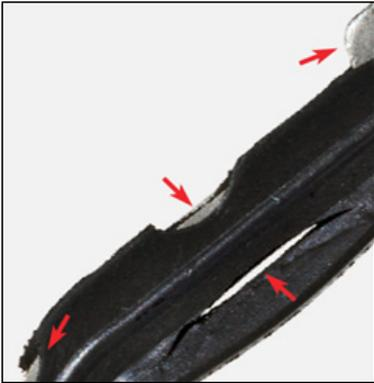
Si se aplica un par de apriete excesivo a este tipo de juntas puede provocar el desprendimiento del caucho. Esto dará origen a una posible pérdida en esa zona.
