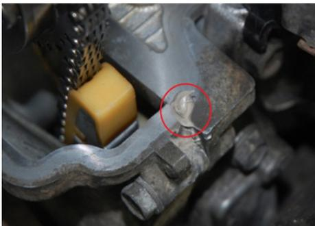
El **exceso de uso de sellante** puede provocar el efecto contrario en este tipo de juntas. Únicamente se han de aplicar en aquellos puntos donde indique el manual o en las transiciones de la superficie a sellar. De lo contrario, un uso excesivo conseguirá que el caucho no realice el sellado correctamente dando lugar, de nuevo, a una pérdida.
