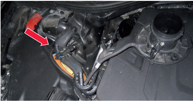
Resim 1: Bir V6 3.0 TDI motorda hava filtresinin montaj konumu
