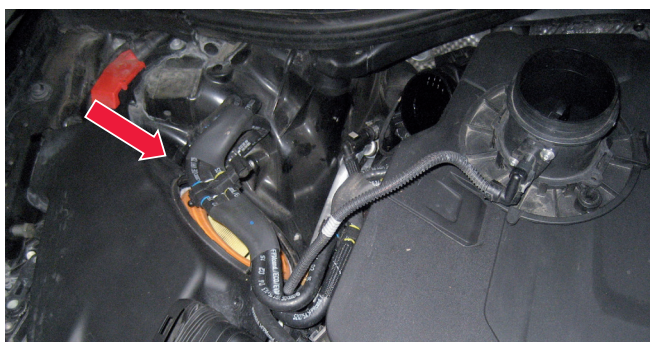
Ilustracja 1. Położenie montażowe filtra powietrza w silniku V6 3.0 TDI
