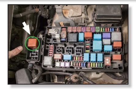
RELAY IS LOCATED AT THE FRONT LEFT-HAND SIDE OF THE ENGINE COMPARTMENT
