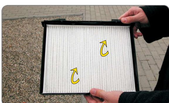
**PL** Wyciągnąć filtr z ramki, zamontować nowy, wykonać powyższe czynności w kolejności odwrotnej
