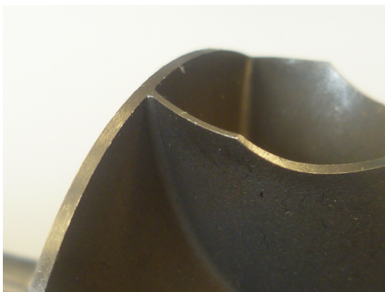
Turbina scarico nuova priva di danni.
