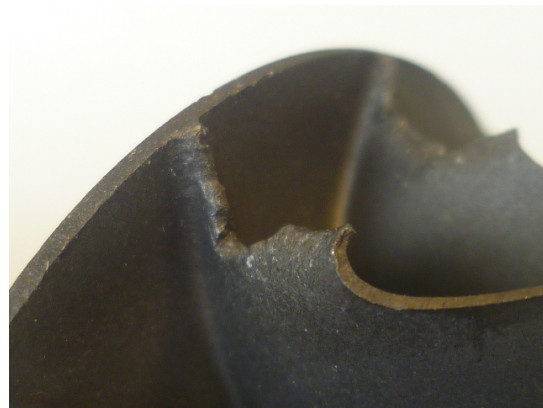
Turbina escape dañada.
