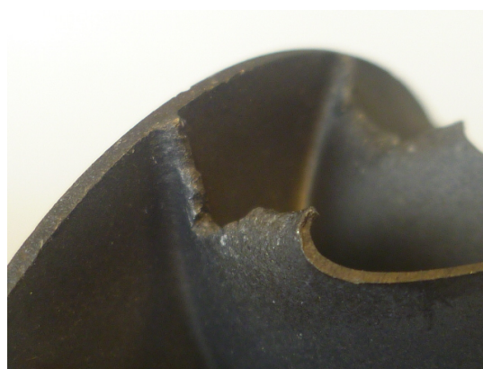
Poškozená výfuková turbína.
