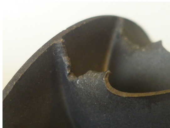
Uitlaatturbine met beschadigingen.
