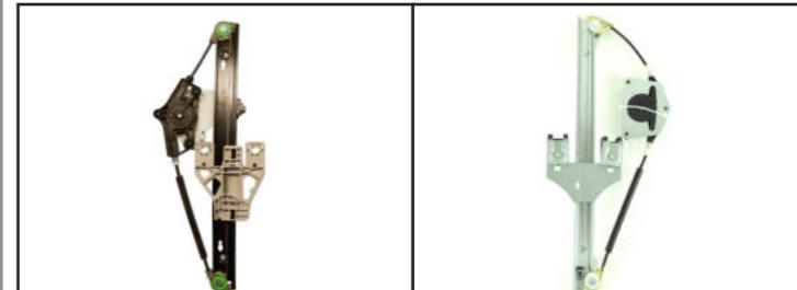
Alzacristallo originale - oem window regulator - lève-vitre original - Fernsterheber von oem - elevavunas original - levantator de vidro original - nosso levantator de vidro - bizim cam acacagi - Γρύλος γνήσιος
