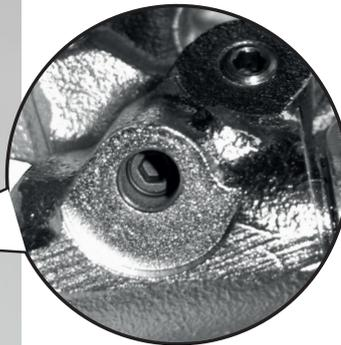
3. Nun wieder etwas gegen den Uhrzeigersinn zurück drehen, bis die Bremse frei dreht.
