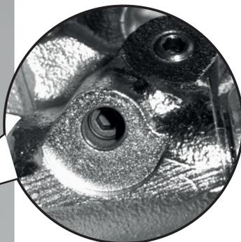
3. Tourner à présent dans le sens inverse des aiguilles d'une montre jusqu'à ce que le frein tourne librement.
