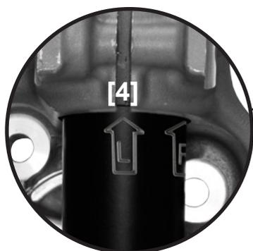
Supporto sinistro del fuso a snodo: montare l'ammortizzatore in modo che la freccia "L" risulti a filo con la cavità [4].
