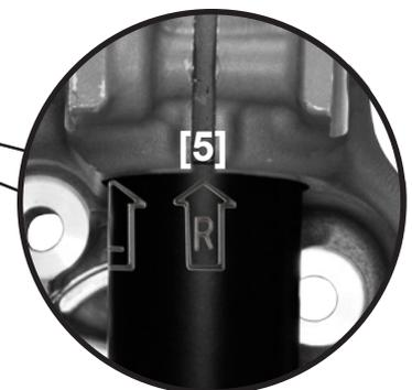
Logement de droite de la fusée d'essieu : Monter l'amortisseur de sorte que la flèche « R » soit alignée avec l'échancrure [5].
