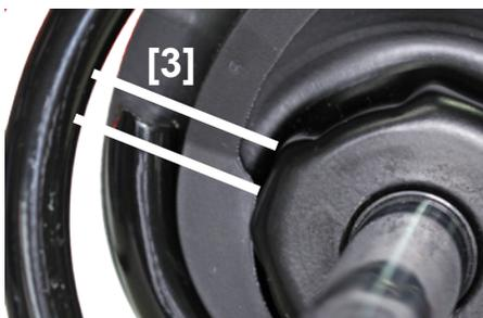
Position correcte du ressort : Le bord du logement du ressort et l'extrémité du ressort doivent être positionnés l'un par rapport à l'autre comme dans l'illustration [3]
