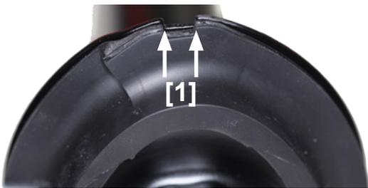
Faire concorder l'échancrure de la jambe de suspension et de la butée en caoutchouc [1].
