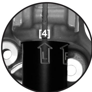
Logement de gauche de la fusée d'essieu : Monter l'amortisseur de sorte que la flèche « L » soit alignée avec l'échancrure [4].
