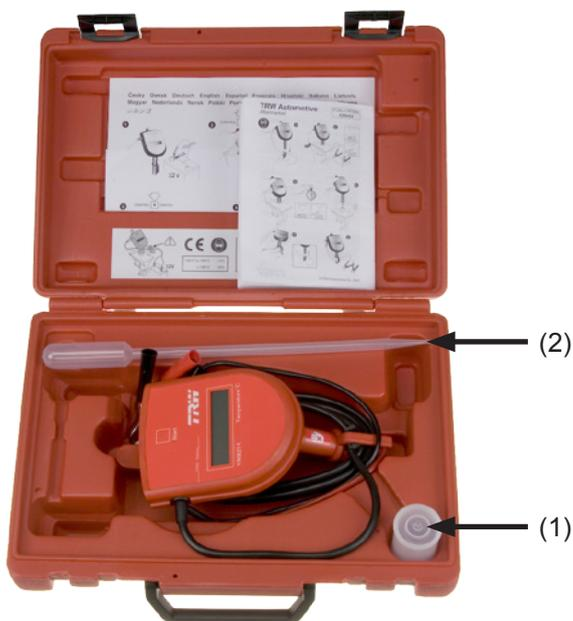
(2) La pipette permet d'effectuer un prélèvement si le réservoir de liquide de frein est difficilement accessible.
