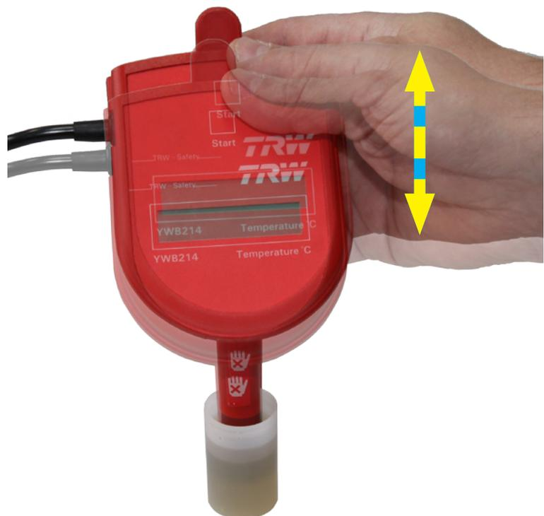
(2) Mit der beigelegten Pipette, können Sie aus ungünstig platzierten Vorratsbehältern Bremsflüssigkeit entnehmen, um sie dann im Probenbehälter zu messen.
