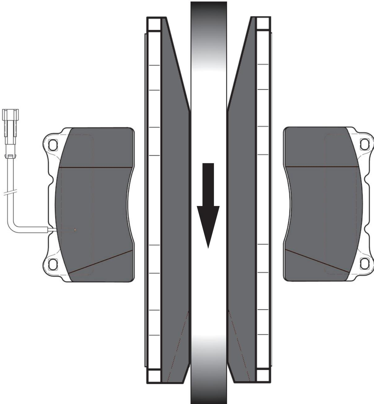
GDB1363 und GDB 1431 sind einseitig angeschrägt. Dies geschieht zur Minimierung von Geräuschen. Der Pfeil zeigt die Laufrichtung der Bremsscheibe. Sind die Bremsbeläge nicht wie gezeigt eingebaut, können Geräusche entstehen. Um sicherzustellen das der Einbau korrekt stattfindet wird TRW in Zukunft einen Pfeil zur Kennzeichnung der Laufrichtung auf der Rückenplatte drucken.
