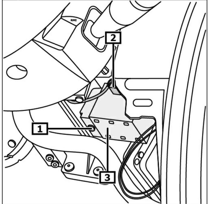
**1** Tornillo/s del dispositivo de control para el cierre electrónico de la columna de dirección
