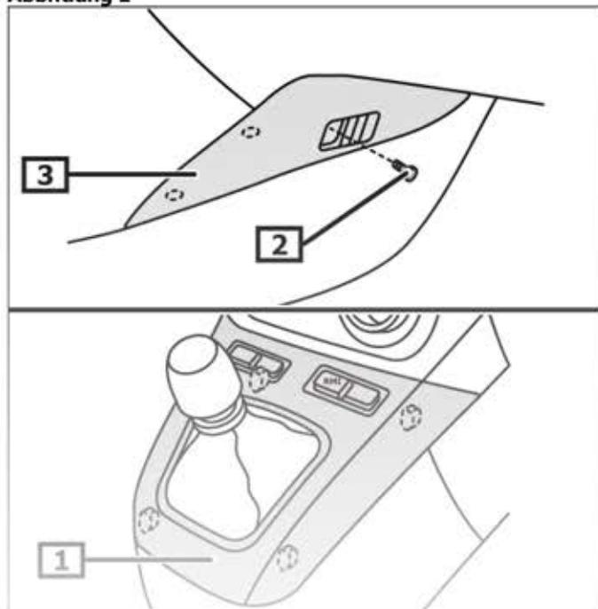
1 Abdeckung(en) - Schalthebel      2 Schraube(n) - Abdeckung
